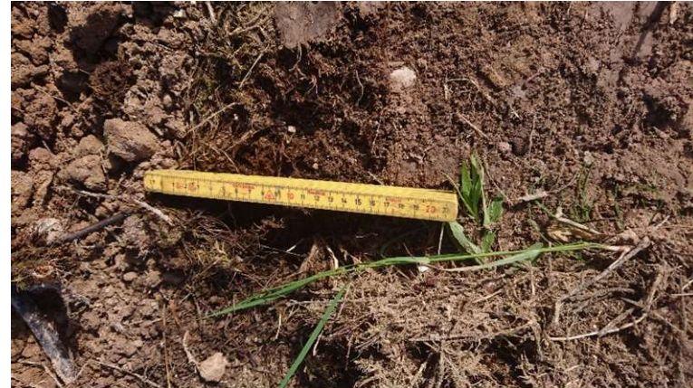
Bild 3. 30 juni. Högsta blyvärdet (394 mg/kg) mättes upp i detta material, ett lager med mulnande vegetation som låg som ett lager ca. 2 meter ned i högen. Sannolikt tippat då lagern i högen varierade från silt – sand – mulljord och vegetation.
